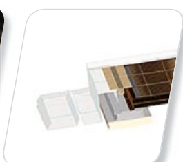
07 Installation de la bande de solin latérale
