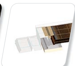
07 Installation de la bande de solin latérale
